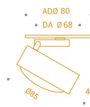
\* passend für UP-Dose ø 68 mm / suitable for cavity wall boxes ø 68 mm
