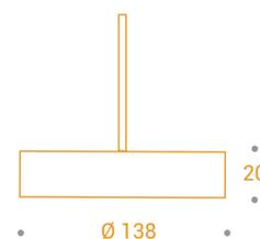
Pendellänge 1,5 m, kürzbar / Pendant cable length 1,5 m, can be shortened
