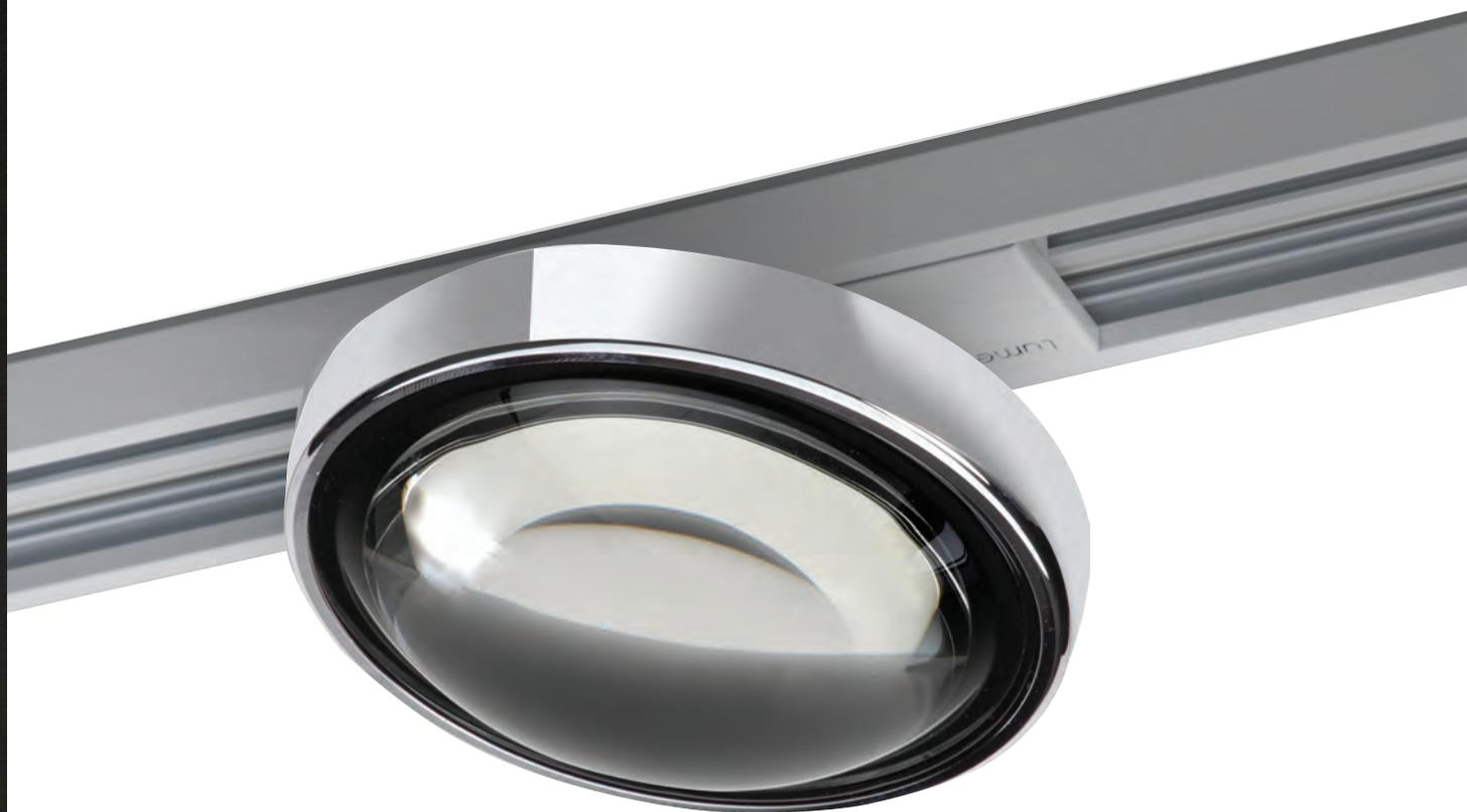
**Fly Systemspot mit Glaslinse** für die TRIvario® Stromschiene, 230 V anschlussfertig. Dimmen über Phasen- oder abschnittdimmer (siehe Seite 107). Schwenkbar 30°. Vom Hersteller austauschbarer Chip. 5 Jahre Garantie auf das LED-Modul.
