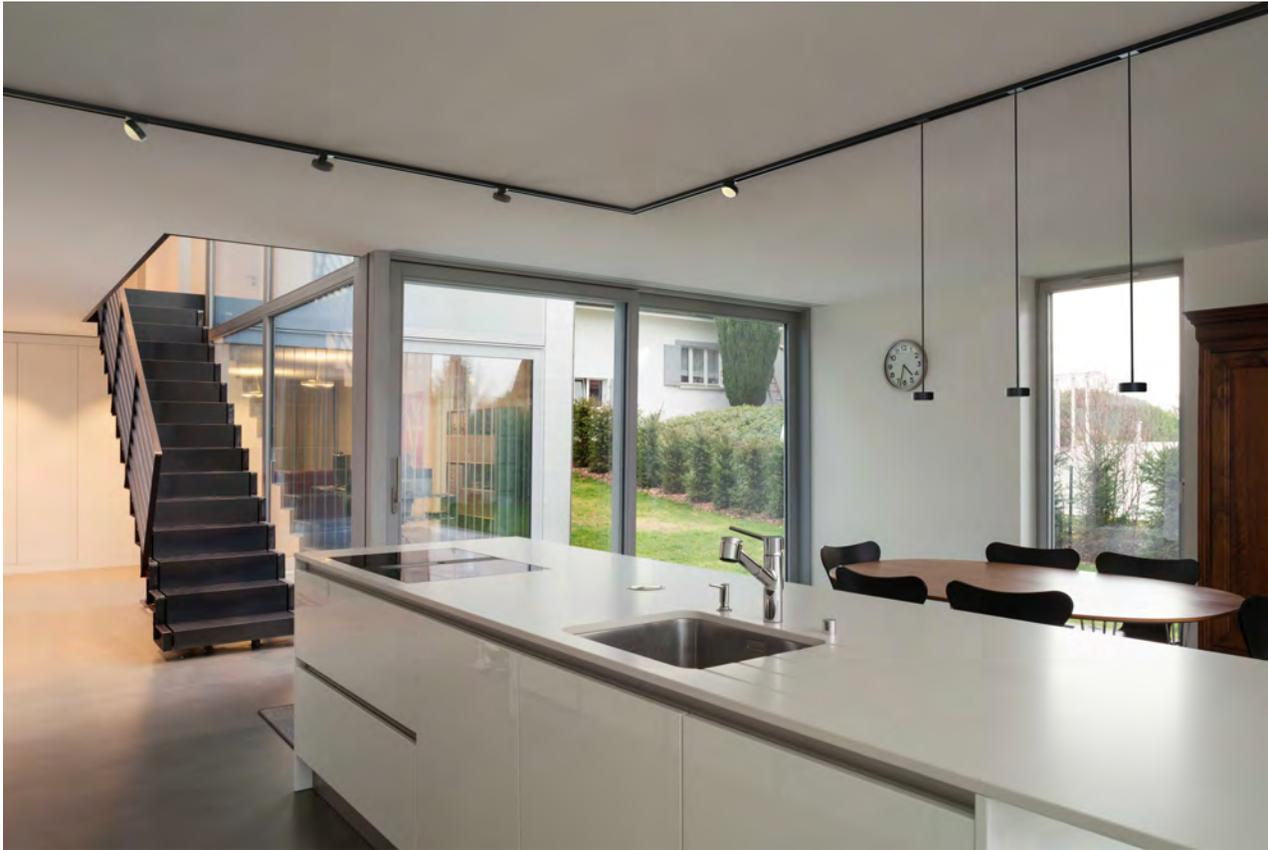
Beim Lichtschienen-System TRLvario® können sowohl Pendelleuchten für den Essplatz als auch Deckenspots für die Raumbelichtung miteinander kombiniert werden.
