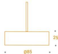
Pendellänge 1,5 m, kürzbar / Pendant cable length 1,5 m, can be shortened
