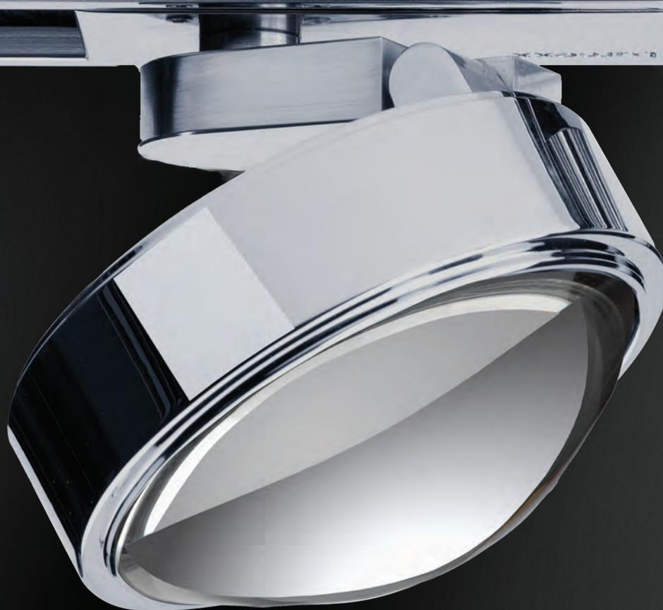
**Nubix Systemspot mit Glaslinse** für die TRIVario® Stromschiene, 230 V anschlussfertig. Leuchtenkopf drehbar: 90° vertikal, 355° horizontal. Abstrahlwinkel 70°. Dimmen über Phasen- oder abschnittdimmer (siehe Seite 107). Vom Hersteller austauschbarer Chip. 5 Jahre Garantie auf das LED-Modul.
